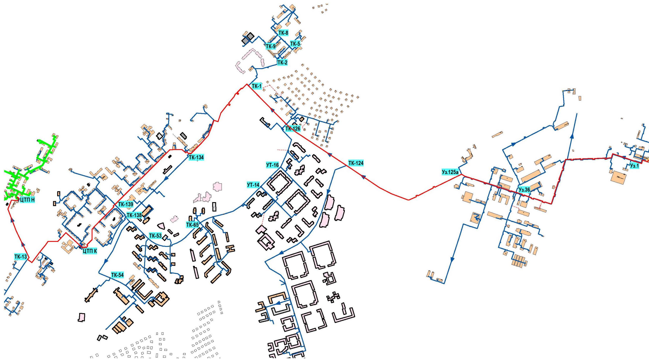
Рисунок № 4. Путь пьезометра “Котельная” — ЦТП микрорайона “Новоборск”
